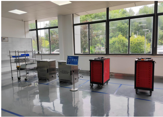
激光光声光谱油中溶解气体在线监测装置 (组装机)
