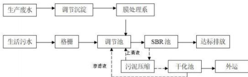
污水处理站工艺流程图
