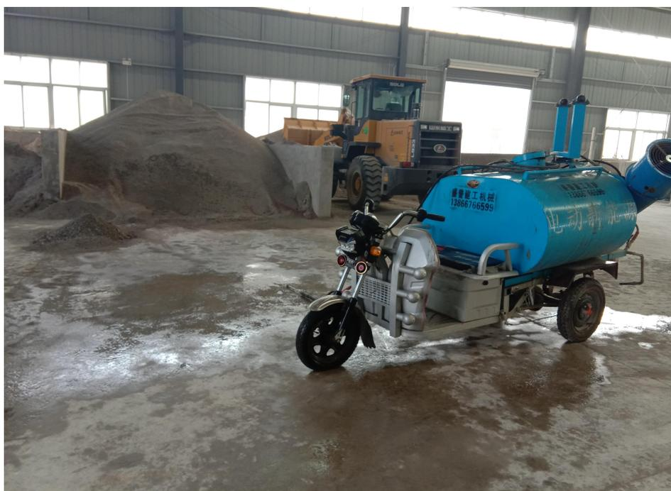
图 3-6 厂区道路硬化，洒水车洒水降尘
