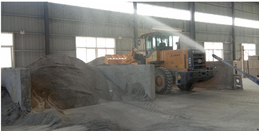
图 3-5 车间封闭、料仓独立设置，喷水雾定期洒水降尘
