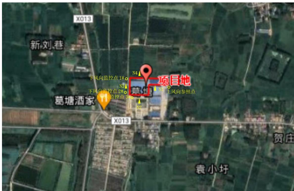
图 6-2 无组织废气和噪声监测点位示意图
